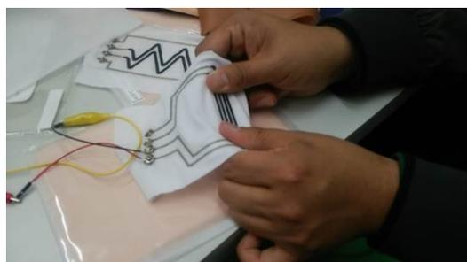
**図 1.3** 布生地を基材とした薄膜皮膚センサ
