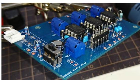
図 2.2e 電子パーツを実装したプリント基板 (左: マイコン等, 三段増幅器等)
